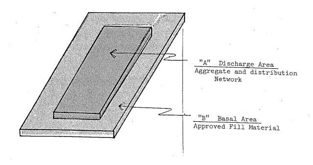
DIAGRAM OF A TYPICAL DISTRIBUTION NETWORK
